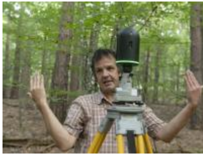
Szalafő Őserdő - Király Géza - 3D lézerszkennelés egy mintvételi pont körül (Fotó: Kovács Márton)
